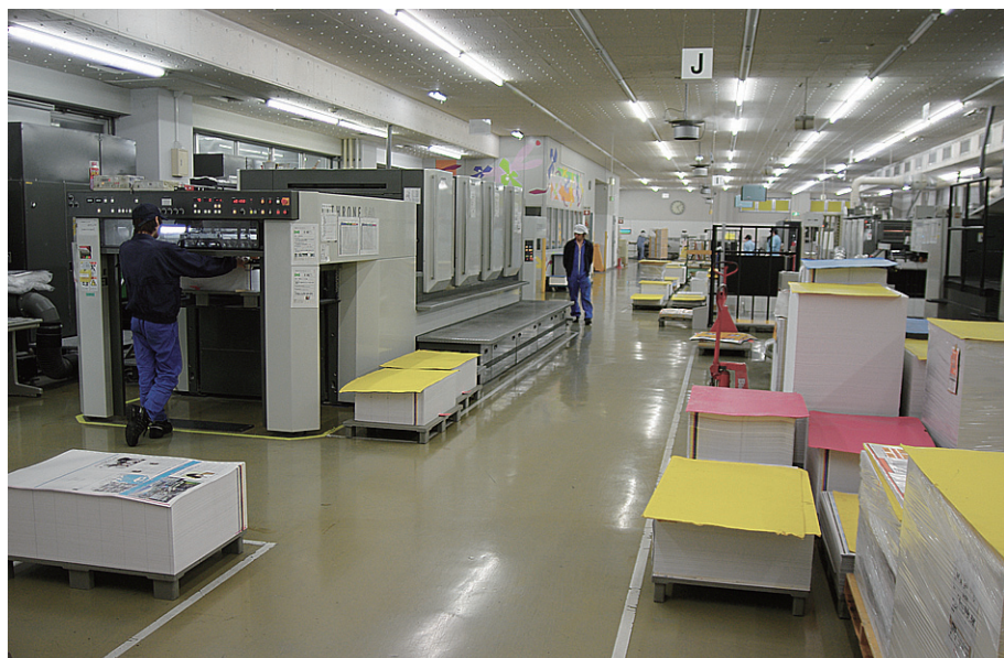
写真・左：天井の光が映りこむほど磨かれた工場の床。一般的には「整理」「整頓」「清潔」「清掃」「検」で5Sと言われるが、同社の活動は「整理」「整頓」「清潔」「清掃」の4S。品質も生産性も、ものづくりのすべての基本は4Sと考え、徹底している。 写真・上：VOC(揮発性有機化合物)の有毒ガスを吸引する設備。最良の生産環境をつくるために、高額な設備を迷わず導入した。
