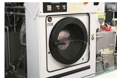
丸洗いは、予洗いをし、蒸留式のドライクリーニングを行なう。その後、真空乾燥をし、臭気抜きをして完成。
