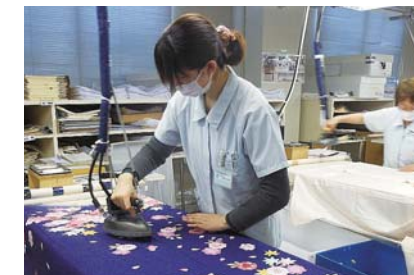
仕上げの工程では、決して直接アイロンを生地にあてない。その後、バキューム装置にて蒸気を取り去る。
