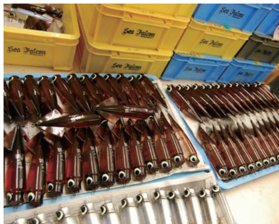
内部の重りを調整し、浮力をコントロールすることに成功。ラメや塗装など、丁寧な仕上がりが愛好家たちから高い評価を得た
