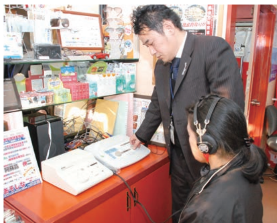
補聴器効果測定器で「聞こえ」の具合を微調整する阿蘇品さん。 装着時と外した時でどれくらい聞こえに差があるかを測定できる
